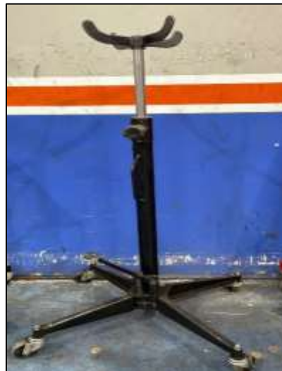
GATA PARA DESMONTAJE DE CAJA DE CAMBIOS MULTIMARCA
