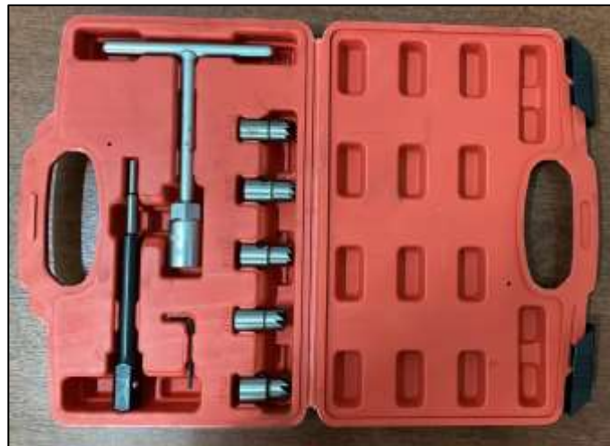
RECTIFICADORA ASIENTOS INYECTORES - MULTIMARCA
