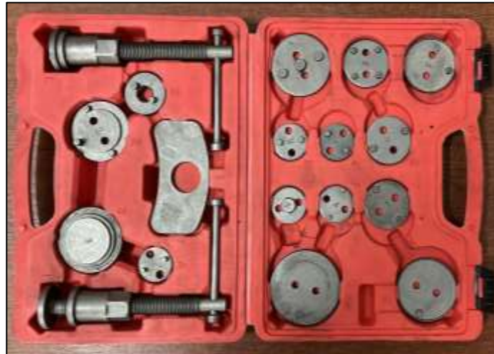
PRENSA PARA CILINDROS DE FRENO MULTIMARCA
